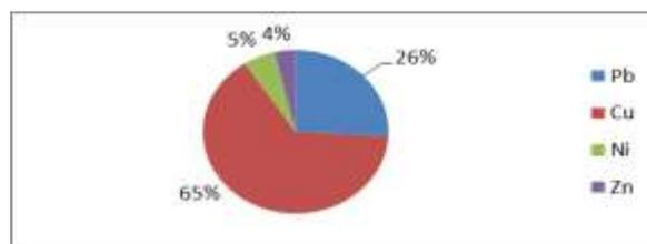
Рис. 6. Концентрации металлов в ТЧ на режиме №12 при Ne=75%, n= 1500 мин<sup>-1</sup>
